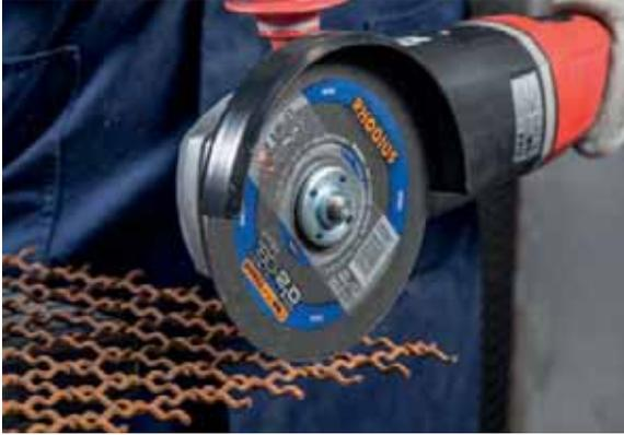
Freihandtrennscheiben kommen meist bei robusten Anwendungen zum Einsatz. Durch ein stärkeres Gewebe und deren Scheibenbreite bis 4 mm bieten Sie eine höhere Seitenstabilität und somit ein sicheres Gefühl beim Trennen von Vollmaterialien.
