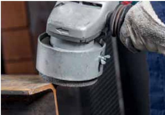
Schleiftöpfe eignen sich besonders gut für den Flächenschliff. Durch die Abstufung der Körnung von 16-60 können sowohl grobe als auch feine Schleifarbeiten ausgeführt werden.
