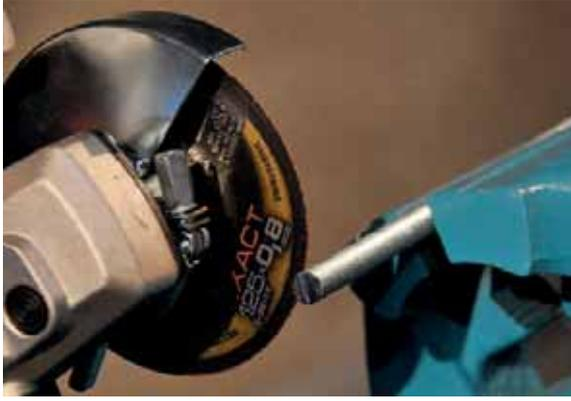
Extradünne Trennscheiben verfügen über eine geringere Reibungsfläche. Dies ermöglicht einen schnellen und kühlen Schnitt.
