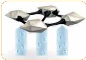
Bei der Lagerung von Schleifscheiben dringt Luftfeuchtigkeit zwischen Bindungsmatrix und Schleifkorn.
