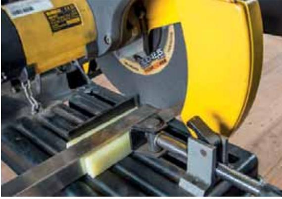
Stationäre Trennscheiben für ortsfeste Trennmaschinen und Kappsägen zeichnen sich durch eine hohe Lebensdauer und Schnittrigkeit aus.
