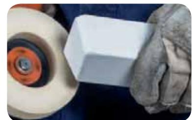
Optimale Verteilung der Polierpasten mit den Filzlamellenscheiben FLS und den Filzlamellenpolierer FLPB
