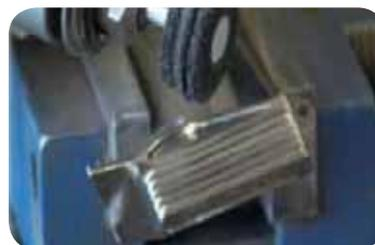
Das verpresste Vliesmaterial der VKS Scheiben und Schaftwerkzeuge kann profiliert werden und passt sich so optimal der Geometrie des Werkstücks an
