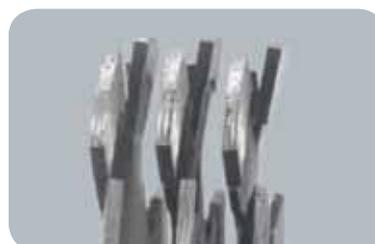
Verschränkte Diamant-Segmente ermöglichen ein Fräsen ohne Steg. Dadurch wird auch das Zusetzen der Scheibe verhindert.
