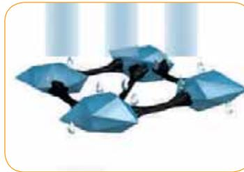
Das vorzeitige Ausbrechen der Schleifkörner wird reduziert und somit die Leistung und Effizienz der Schleifscheibe optimiert.
