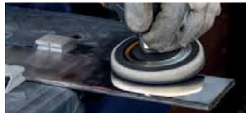
Filzlamellenpolierer zur Bearbeitung von Oberflächen bis hin zum Spiegelglanz. Nutzen Sie Filzlamellenpolierer mit den entsprechenden Polierpasten zum Vorpolieren und Hochglanzpolieren.
