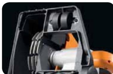
Maßarbeit. Weil die Achse – und damit die Scheibe – extrem weit vorne positioniert ist, sind Schnitte bis zu 23 mm an der Gerätekante möglich.
