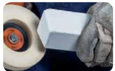
Die FLS gewährleistet durch Filzlamellen die optimale Verteilung der Polierpaste
