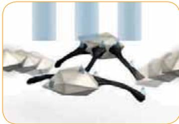
Die Verbindung wird geschwächt und das Korn bricht während des Trennprozesses wirkungslos aus.
