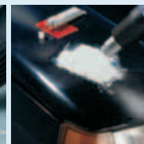
Сварка с зеркальной насадкой
