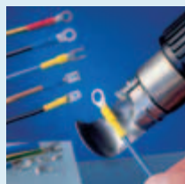
Усадка изоляции кабеля
