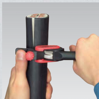
Вращение инструмента для разреза по окружности
