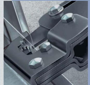
Пуансон инструмента продавливается через профили
