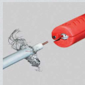
Удаление изоляции проводника в коаксиальном кабеле
