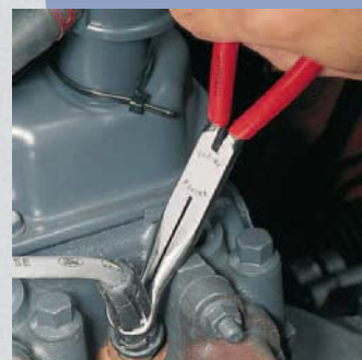
Губки особой формы для удобства снятия штекеров проводов свечей зажигания
