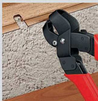
Легкое вырубание профилей благодаря высокому передаточному отношению рычагов
