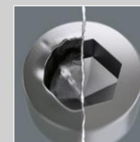
Г-образные ключи позволяют передавать высокие крутящие моменты. Поэтому ноу-хау фирмы Wera по изготовлению изделий с малыми допусками, тщательный выбор материалов и отточенная техника закалки металла гарантируют максимальную безопасность на рабочем месте.
