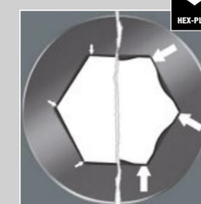
Г-образные ключи Hex-Plus фирмы Wera располагают большими опорными поверхностями в головке винта и, таким образом, уменьшают вероятность появления разрушительных зарубок на винте.
