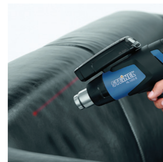
Разглаживание кожи при оптимальной температуре под контролем HL Scan
