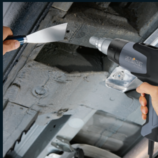
Удаление антикоррозийного покрытия кузова
