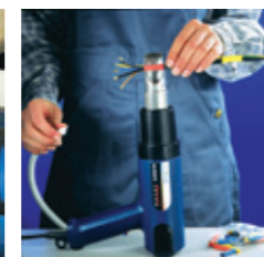
Усадка изоляции кабеля
