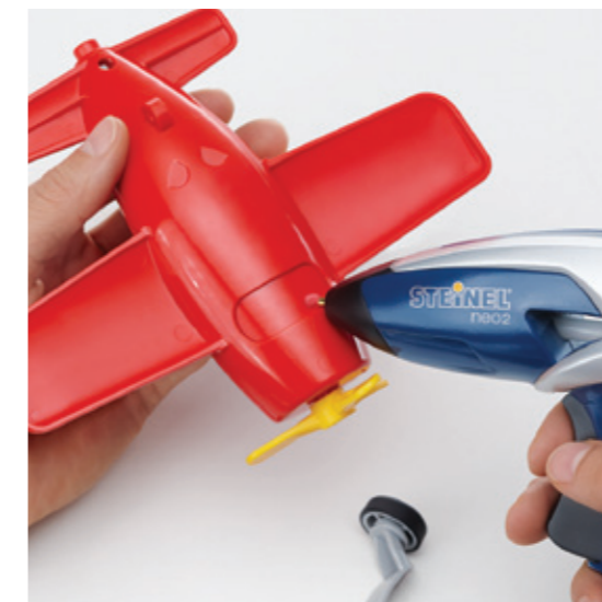
Ремонт пластиковой игрушки с помощью горячего клея
