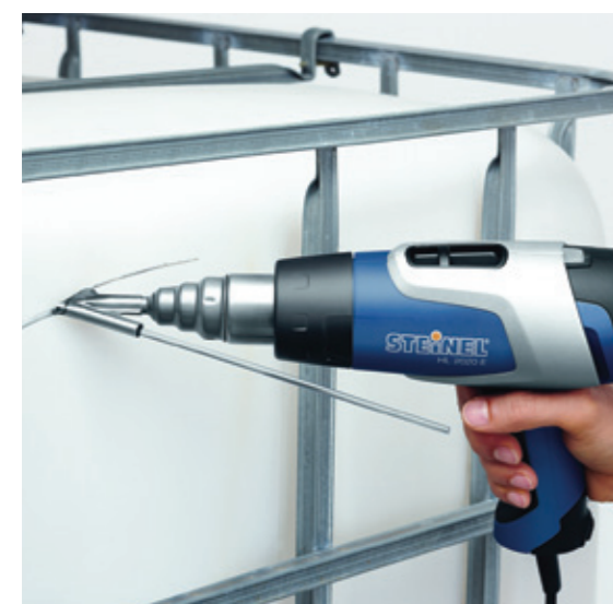
Ремонт. Заваривание ПВХ-бака для воды
