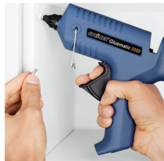
Фиксация. Можно зафиксировать держатели полок в шкафах
