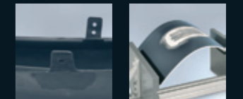
Сварка на проушинах
