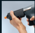
Установить нагревательную головку
